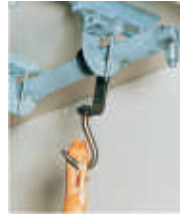
Rohrbahnen nach EU-Norm mit Sicherungsbügel für Eurohaken und Rohrbahnanschluß für direkte Verladung aus dem Schlachthaus.
