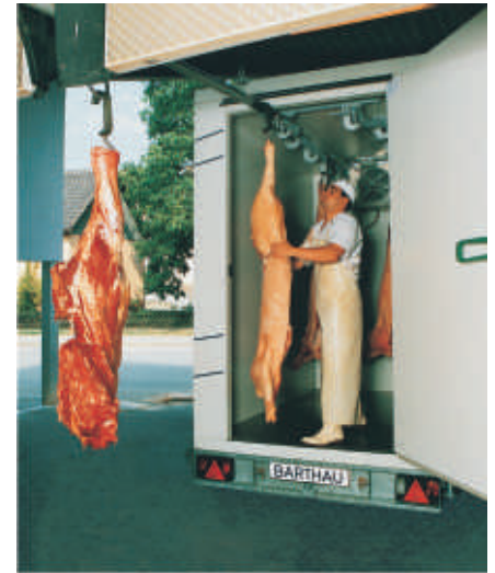
IK 2702, Innenmaße: 2940 x 1440 x 2300 mm. Anhänger mit Dachverstärkung und 2 verzinkten Rohrbahnen nach EU-Norm mit Rohrbahnanschluß. Zum Transport von hängendem Fleisch. Tragkraft pro Rohrbahn max. 670kg. Die Konsolen mit Sicherungsbügel verhindern das Verrutschen der Ladung.
