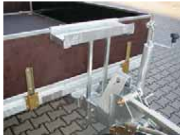
Baggerlöffelablage , an Bordwand montiert, mit Abstützung auf die Zugdeichsel. Verwendung bei V-Deichsel und höhenverstellbarer Auflaufbremse möglich.
