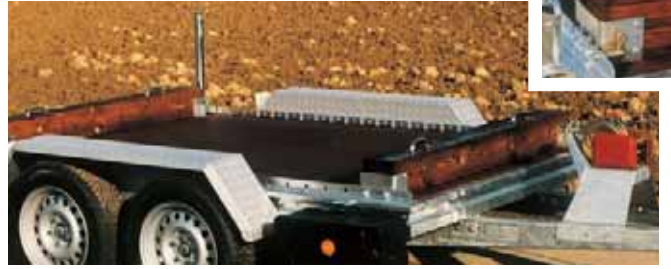
Zubehör: Ladungssicherung mit 2 Sperrbalken in Arretierschienen über die gesamte Anhängerlänge verstellbar, Seilwinde mit Windenbock auf V-Deichsel.
