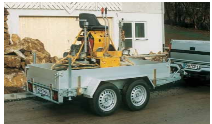
MT 2002 mit Zubehör: Aluminium-Bordwände 400 mm hoch, werkzeuglos abnehmbar, Rohrstützen mit doppelter Klemmhalterung.
