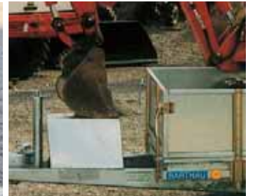
Baggerlöffelablage , auf V-Deichsel montiert. Stützrad platzsparend in den Zugholmen befestigt.
