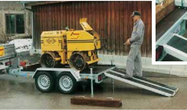
MT 2702 mit Zubehör: Seilwinde 900 kg, stabiler Windenbock, Ladungssicherung für Walzentransporte, Aluminium-Auffahrampen mit Antirutsch-Gummibelag inkl. Halterungen und Rohrstützen.
