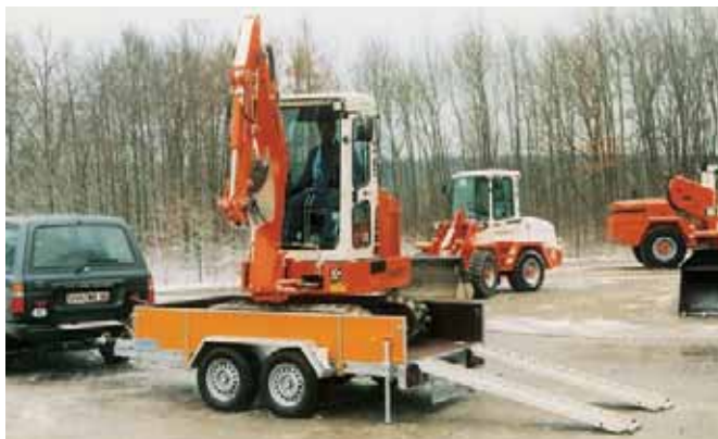
MT 3502 mit Zubehör: abnehmbare Multiplex-Bordwände , auf Wunsch außen in RAL-Ton lackiert und Alu-Auffahrampen inkl. Rohrstützen . Der Bagger läßt sich bei eingesteckten Bordwänden drehen.
