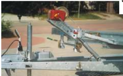
Zentralverriegelung zur Sicherung der Kippeinrichtung, wird nur auf rechter Seite bedient. Stützrad schwer, automatisch umklappbar. Zweistufiger Teleskopzylinder. Zubehör: Seilwinde.
