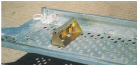
Verstellkeile zur Ladungssicherung, über die gesamte Anhängerlänge verstellbar. Gurtösen, am Rahmen angeschweißt. Zurrösen beweglich und verstellbar je nach Länge des Fahrzeug über die gesamte Anhängerlänge.
