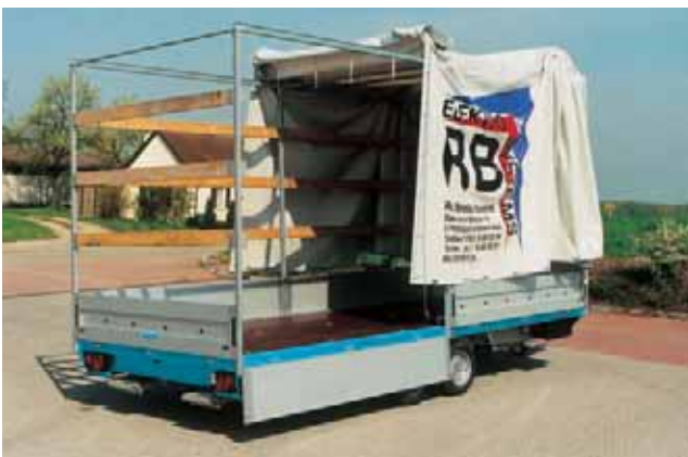
Typ SP mit Aluminiumrampen und mit Schiebeverdeckgestell , für Kranverladung geeignet, als Zubehör. Bordwände mit Mittelrungen.
