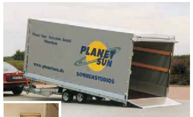
TK 3002 mit Dachgestell und PVC-Plane mit Beschriftung. Zubehör: Alu-Arretierbleche mit Verstellkeilen für Autotransport.
