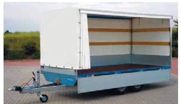
SP Zubehör PVC-Plane und Dachgestell aus verzinktem Vierkanthrohr geschraubt mit 100mm Steigung. Besonders zu empfehlen ist, wenn das Dachgestell und die Plane als Schiebeplane ausgerüstet werden. Die Schiebeplane mit Leichtlaufrollen aus Polyamid läßt sich spielend leicht nach vorne ziehen, der Anhänger ist schneller offen. Bei normaler Plane lässt sich eine große Plane nur schwer nach oben werfen und der Wind weht sie leicht wieder herunter. Jede Höhe für Anhänger lieferbar, jedoch nicht mit einschiebbarer Plane (Kasackplane) und nicht mit Zollverschluß.
