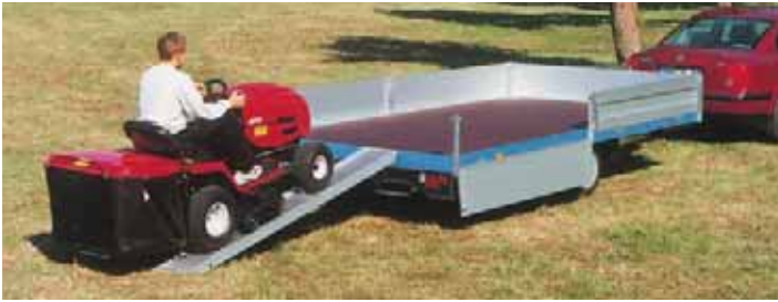
TP 3502 serienmäßig: Mit patentierter Außenrahmenladungssicherung TOPZURR21 rundherum. Eloxierte Aluminium-Bordwände, ringsum abklappbar und abnehmbar, Eckrungen steckbar, Ladehöhe 680 mm. Zubehör: Aluminium-Auffahrampen 2500 x 350 mm mit Rampenhalterungen unter dem Anhänger, Klappstützen, Bordwände seitlich in der Mitte mit steckbarer Mittelrunge geteilt.
