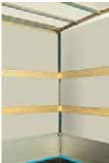
Einschiebbares Dachgestell und PVC-Plane als Zubehör. Linke und rechte Abbildung: ausgezogen auf 2100 mm Ladehöhe. Mittlere Abbildung: eingeschoben auf 1600 mm Ladehöhe. Es werden alle 4 Eckpfosten oben eingeschoben, deshalb ist nicht die ganze Last des Daches zu bewegen. Die Plane hat 2 Reihen Befestigungsösen rundum. Bei eingeschobenem Dachgestell wird der untere Teil der Plane nach innen hochgeklappt und mit Klettverschluß befestigt (Kasackausführung). Die Plane wird dann mit den oberen Ösen montiert.
