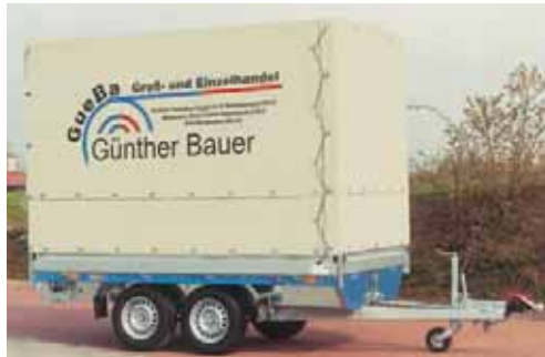
Einschiebbares Dachgestell und PVC-Plane als Zubehör. Linke und rechte Abbildung: ausgezogen auf 2100 mm Ladehöhe. Mittlere Abbildung: eingeschoben auf 1600 mm Ladehöhe. Es werden alle 4 Eckpfosten oben eingeschoben, deshalb ist nicht die ganze Last des Daches zu bewegen. Die Plane hat 2 Reihen Befestigungsösen rundum. Bei eingeschobenem Dachgestell wird der untere Teil der Plane nach innen hochgeklappt und mit Klettverschluß befestigt (Kasackausführung). Die Plane wird dann mit den oberen Ösen montiert.
