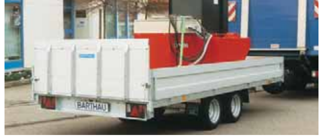
TK 3502 serienmäßig mit hydraulisch kippbarer Ladefläche und überfahrbarer Heckklappe, 670 mm lang, mit Aluminium-Riffelblech belegt. Bordwände seitlich und vorne klappbar.
