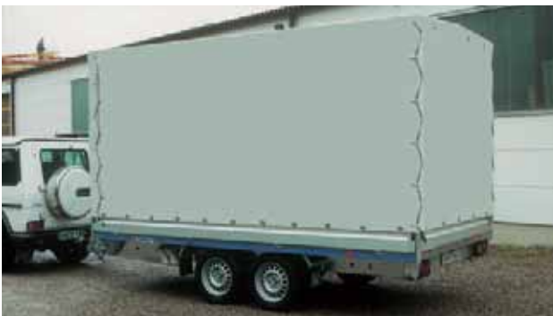
SP Zubehör PVC-Plane und Dachgestell aus verzinktem Vierkanthrohr geschraubt mit 100mm Steigung. Besonders zu empfehlen ist, wenn das Dachgestell und die Plane als Schiebeplane ausgerüstet werden. Die Schiebeplane mit Leichtlaufrollen aus Polyamid läßt sich spielend leicht nach vorne ziehen, der Anhänger ist schneller offen. Bei normaler Plane lässt sich eine große Plane nur schwer nach oben werfen und der Wind weht sie leicht wieder herunter. Jede Höhe für Anhänger lieferbar, jedoch nicht mit einschiebbarer Plane (Kasackplane) und nicht mit Zollverschluß.
