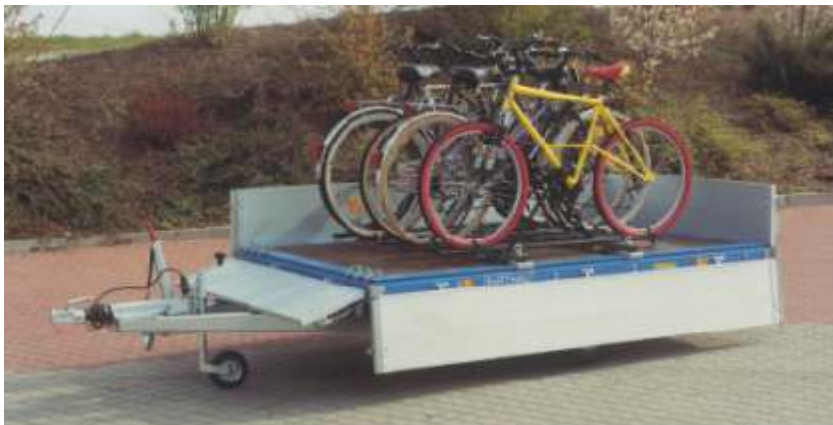
ECO-Toplader mit Lastenträger am seitlichen Zurrprofil festgeklemmt. Am Lastenträger können bis zu 9 Fahrradträger montiert werden. Die Lenker dürfen aber nicht überstehen, sondern müssen an den beiden äußeren Fahrrädern gedreht werden.
