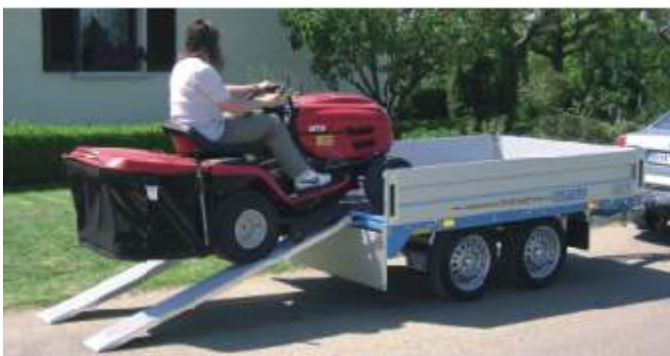
EH 1602 befahrbar durch Aluminium-Rampen 2000 mm lang, 220 mm breit, Tragkraft lt. Prospekt 0.2. Die Rampen haben eine griffige Lauffläche und sind durch die Bolzenarretierung gegen Abrutschen gesichert. Zum Transport können die Rampen in Halterungen unter der Ladefläche eingeschoben oder lose auf den Anhänger gelegt werden. Bei Länge 2010 mm und Breite 1260 mm können die Rampen nur lose auf dem Anhänger transportiert werden, da für diese Größen keine Halterungen unter dem Anhänger montiert werden können. (Bei Auffahrampen mit Halterungen kann keine Ersatzradhalterung unter dem Boden montiert werden.)
