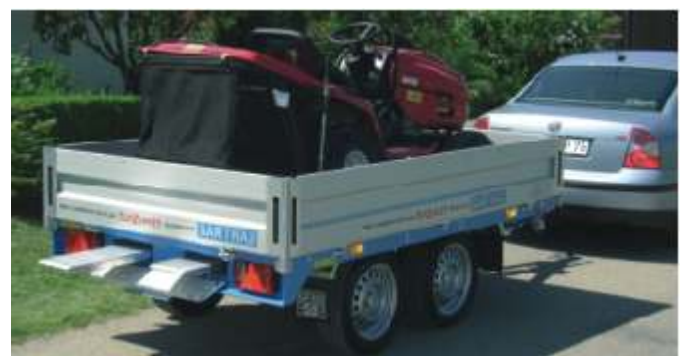
EH 1602 befahrbar durch Aluminium-Rampen 2000 mm lang, 220 mm breit, Tragkraft lt. Prospekt 0.2. Die Rampen haben eine griffige Lauffläche und sind durch die Bolzenarretierung gegen Abrutschen gesichert. Zum Transport können die Rampen in Halterungen unter der Ladefläche eingeschoben oder lose auf den Anhänger gelegt werden. Bei Länge 2010 mm und Breite 1260 mm können die Rampen nur lose auf dem Anhänger transportiert werden, da für diese Größen keine Halterungen unter dem Anhänger montiert werden können. (Bei Auffahrampen mit Halterungen kann keine Ersatzradhalterung unter dem Boden montiert werden.)
