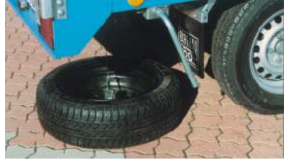
Zubehör: Ersatzrad mit Halterung unter dem Anhänger angebracht. Das Rad wird mit einem Knebel über eine Hebewinde nach oben gedreht und mit 2 Radbolzen fest arretiert.
