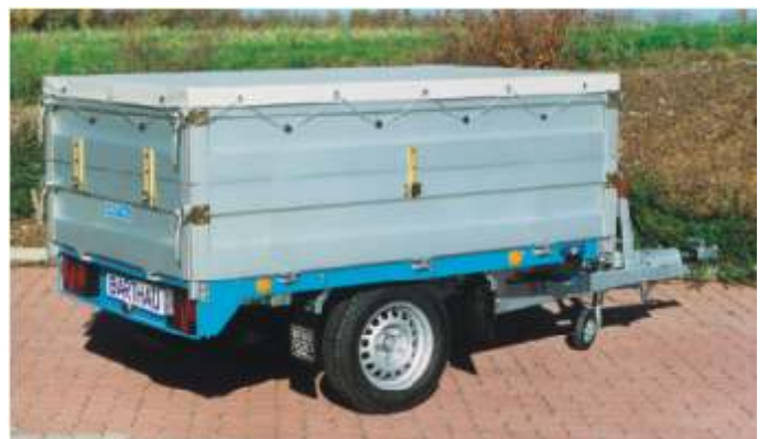
EH 1001 mit Zubehör: Aluminium-Aufsatz 350 mm hoch, werkzeuglos steckbar und Flachplane, serienmäßig in hellgrau.
