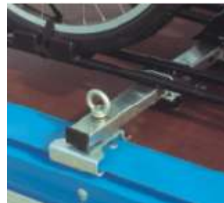
ECO-Toplader mit Lastenträger am seitlichen Zurrprofil festgeklemmt. Am Lastenträger können bis zu 9 Fahrradträger montiert werden. Die Lenker dürfen aber nicht überstehen, sondern müssen an den beiden äußeren Fahrrädern gedreht werden.
